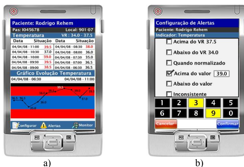
Figura 5. a) consulta individual da variável temperatura; e b) configuração de alertas.
